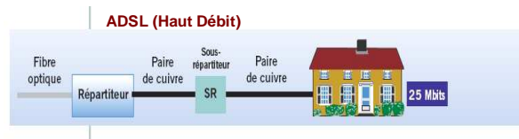
Figure 2 : Architecture du réseau ADSL
